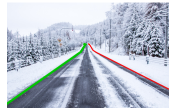
Délimitations virtuelles Exemple de ligne virtuelle délimitant la zone de surveillance d'une route.
