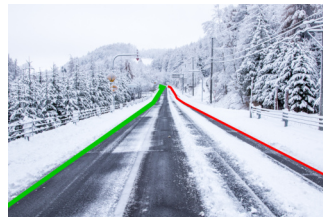
Linea virtuale Esempio applicato di una zona sorvegliata con una linea virtuale
