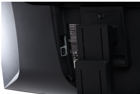
A bal oldali csatlakozások: Táp és hálózati kapcsoló
