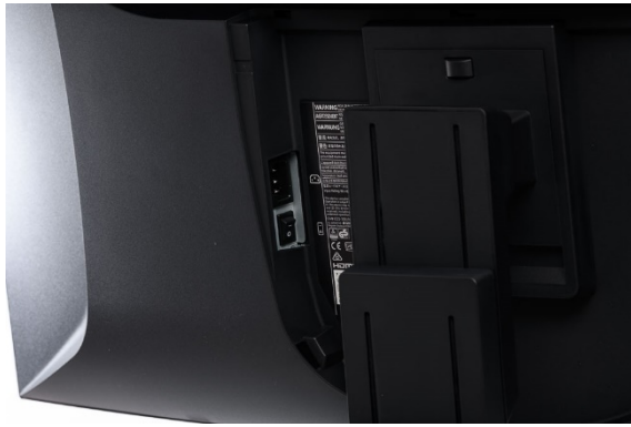
Connexions sur la gauche : Alimentation et interrupteur principal
