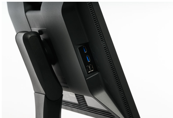
Ports USB latéraux faciles d'accès, 2 x USB 3.0 et 2 x USB 2.0
