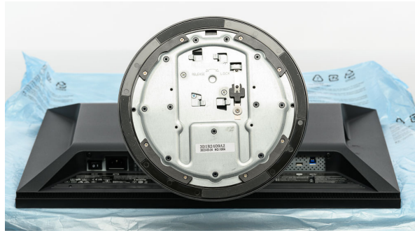
Fixation par vis à oreilles
