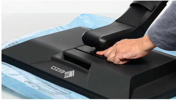
Montaje de la pata de apoyo
