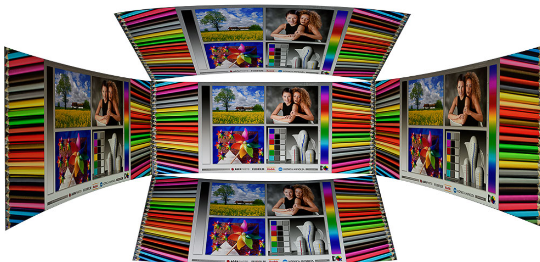
Horizontální a vertikální pozorovací úhly
