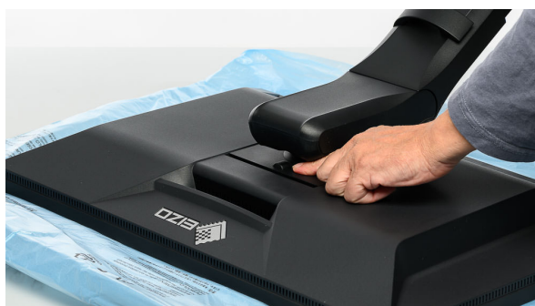
Montáž opěrné nohy
