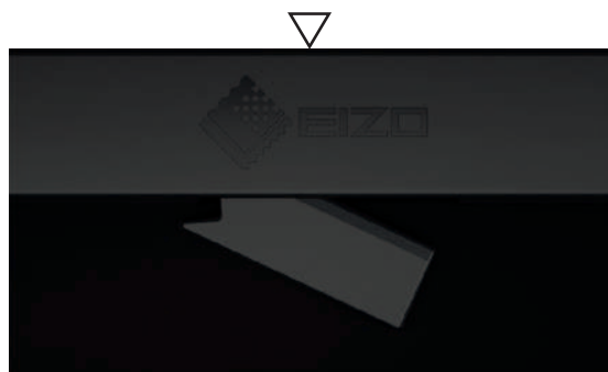
Vestavěná sonda se při kalibraci sama vysune ze svého úkrytu pod horním rámečkem displeje.
